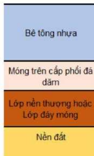
b) Áo đường mềm gồm nhiều lớp bê tông nhựa dày. Lớp trên cùng có thể là bê tông nhựa polime, SMA hoặc bê tông nhựa rỗng thoát nước
